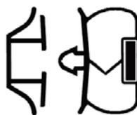
Le joint est facilement interchangeable. Tirer simplement l'ancien joint hors de la gorge. Clipser le nouveau joint à partir du centre en suivant la gorge au long du joint, continue sur les autres côtés en clipsant les coins en dernier.
